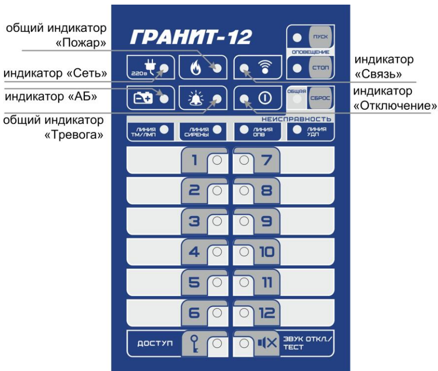
Рис.2 Панель индикации и управления прибора Гранит-12
