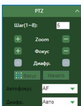
Меню **Управление PTZ** позволяет оперативно управлять поворотными камерами и камерами с моторизованным объективом.
