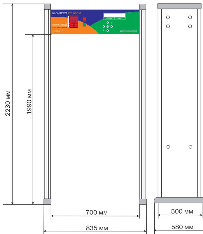
Электрическое напряжение: 85-264 В переменного тока / 47,5-60 Гц
