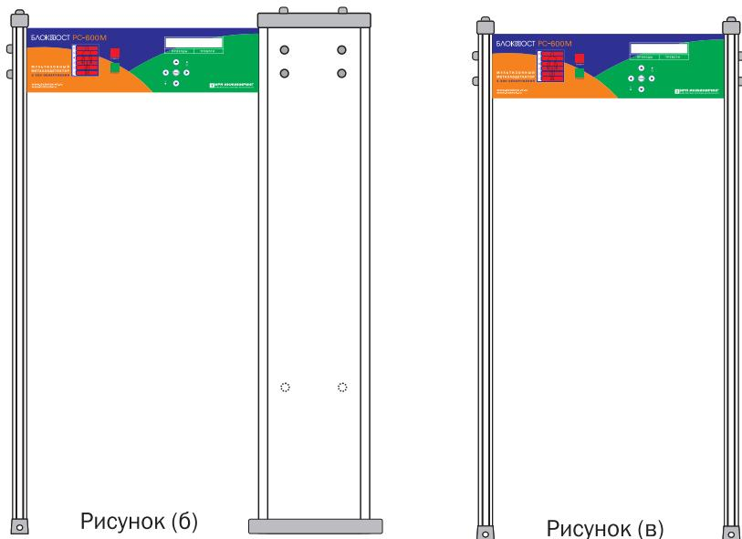
Панели и блок управления поочередно соедините между собой болтами. В блоке управления подключите слаботочный контрольный шлейф.
