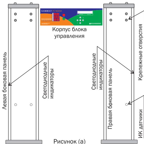
Панели и блок управления поочередно соедините между собой болтами. В блоке управления подключите слаботочный контрольный шлейф.
