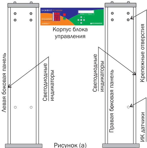
**Соединение боковых панелей с блоком управления производить только в горизонтальном положении!**
