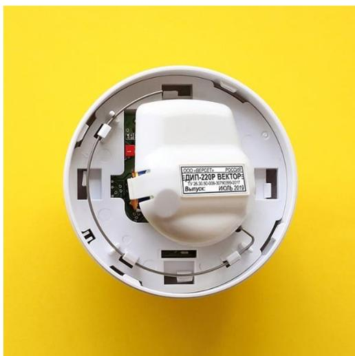
2.2. Отведите отверткой 4 защелки в корпусе:
