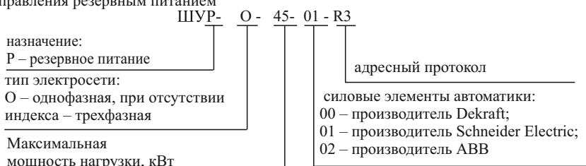
Пример записи трехфазного ШУР мощностью 45 кВт при заказе и в технической документации:
