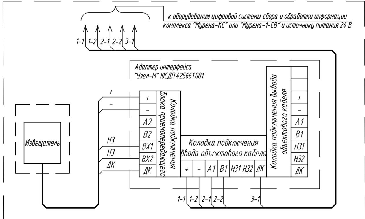
Вариант подключения извещателя с выходным интерфейсом RS-485
