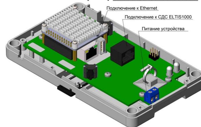
Рис.1 Вид GT-1000IP-1 со снятой крышкой
