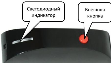
Устройство оснащено двухцветным светодиодным индикатором и двумя кнопками – внутренней и внешней. Внутренняя кнопка служит также датчиком вскрытия корпуса (тампером).
