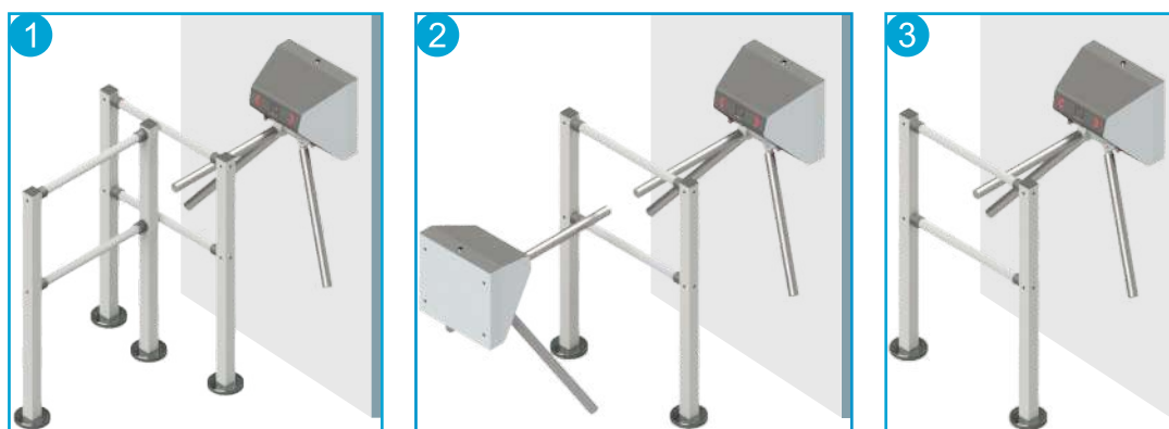
1 2 3 -турникет установлен правильно
