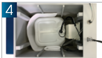
Соединительные элементы подачи дезраствора и подключение электропитания
