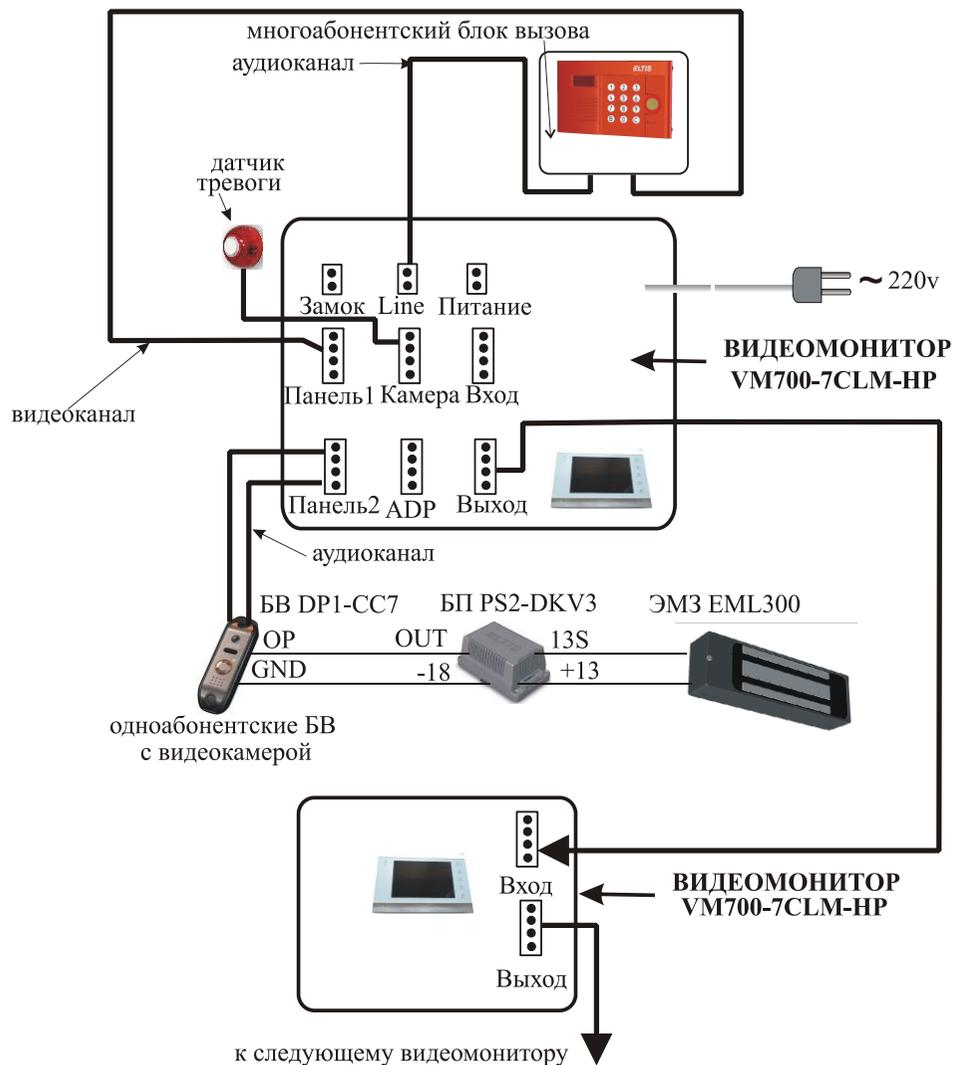
Рис.1 Общая схема подключения видеомонитора.
