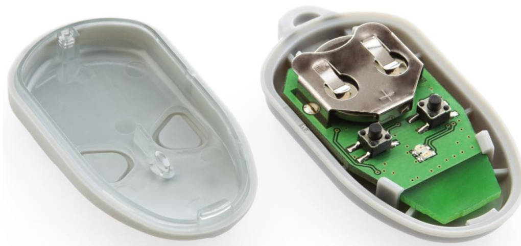
Рисунок 2. Идентификатор со снятой крышкой. Видна батарея питания
