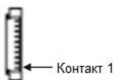
Рисунок 52. Ориентация штырькового 10-ти контактного разъема двухроторного вентилятора
