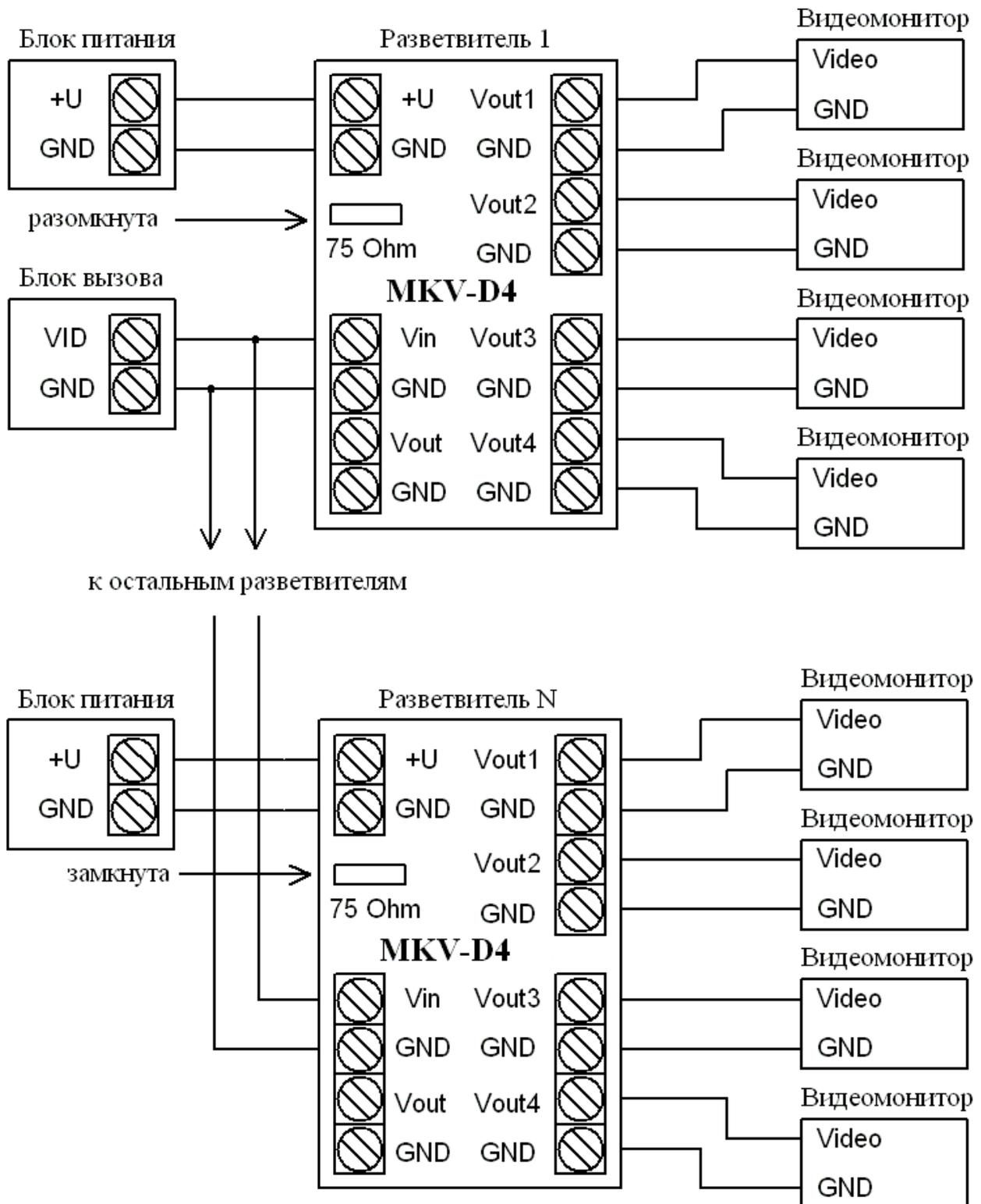
Рисунок 1. Схема подключения разветвителя МЕТАКОМ MKV-D4.
