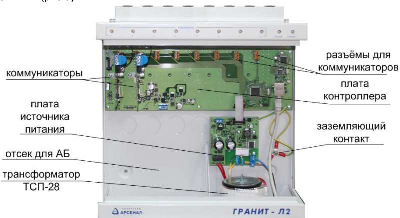
Рис.3 Внешний вид прибора с открытой крышкой
