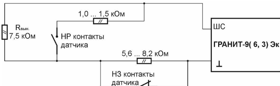
Рис.6. Схема включения технологических датчиков в ШСТ.
