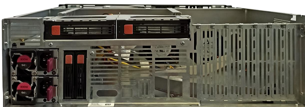
Рисунок 1. Серверная платформа QSRV-361602-E-R (Вид сзади)
