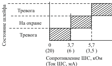
Рисунок 5 – Шлейф охранных извещателей (тип 6)
