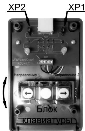
Вид пульта со снятой крышкой
