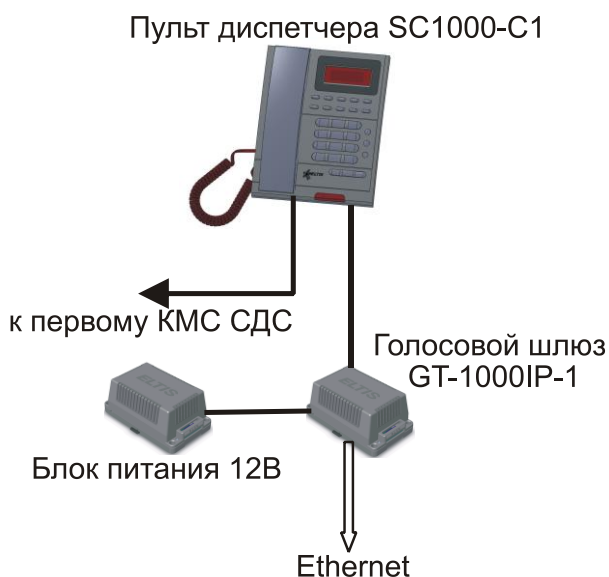
Рис.21 Структурная схема СДС к использованию ГШ GT-1000IP-1
