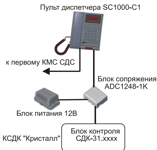
Рис.20 Структурная схема подключения СДС к КСДК «Кристалл»
