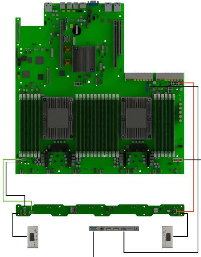
Рис. 25. Схема прокладки системных кабелей и кабелей питания
