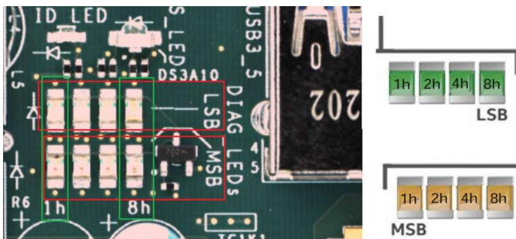
Рис. 8. Расположение и определение POST CODE LED
