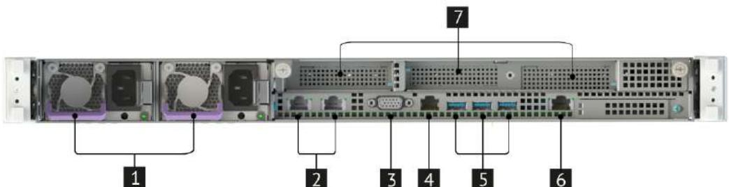
**Рис. 3. Вид сервера сзади**
