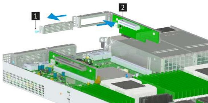
Рис. 47. Установка карт расширения в PCIe-рейзер
