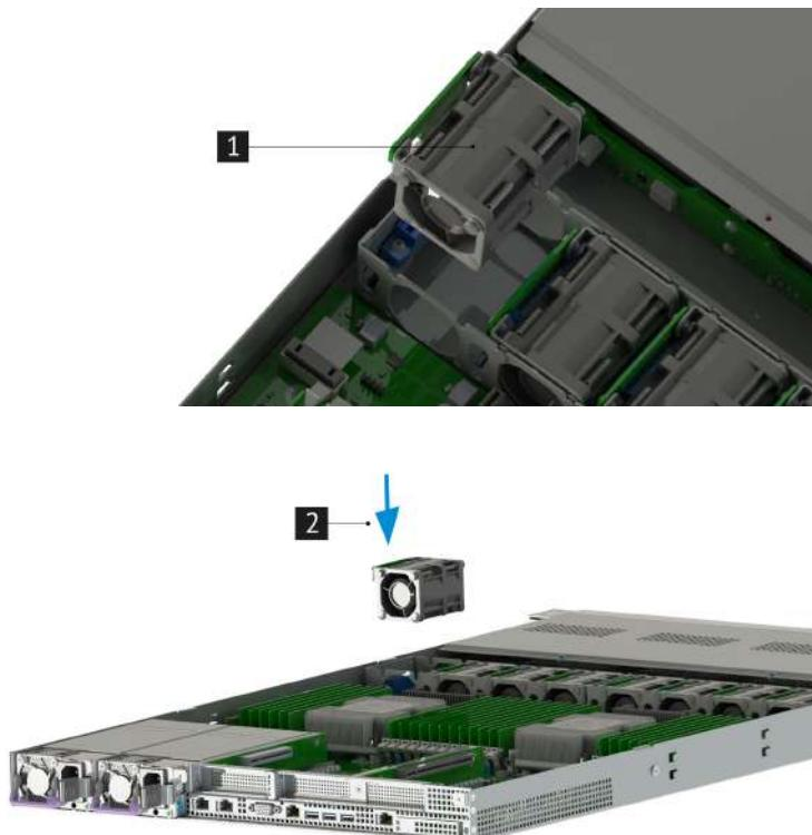
Рис. 29. Подключение вентилятора.
