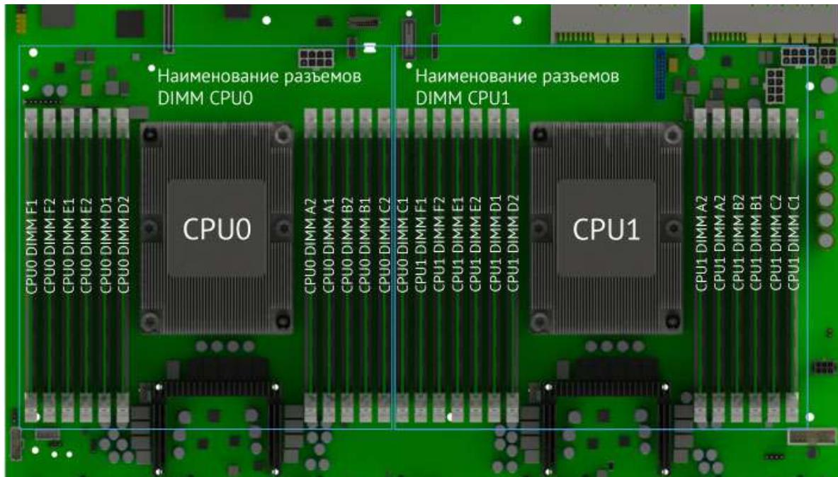
Рис. 30. Расположение разъемов.
