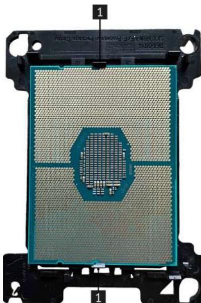
Рис. 35. Снятие процессора с радиатора
