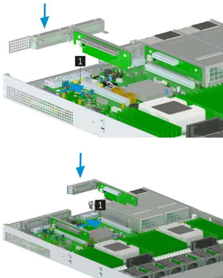
Рис. 46. Установка PCIe-райзера с основанием в корпус сервера
