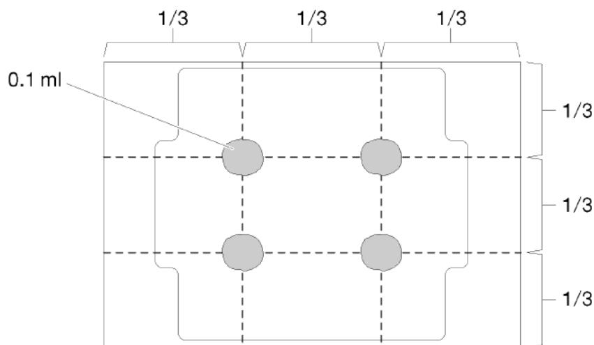
**Рис. 36. Нанесение термопасты**
