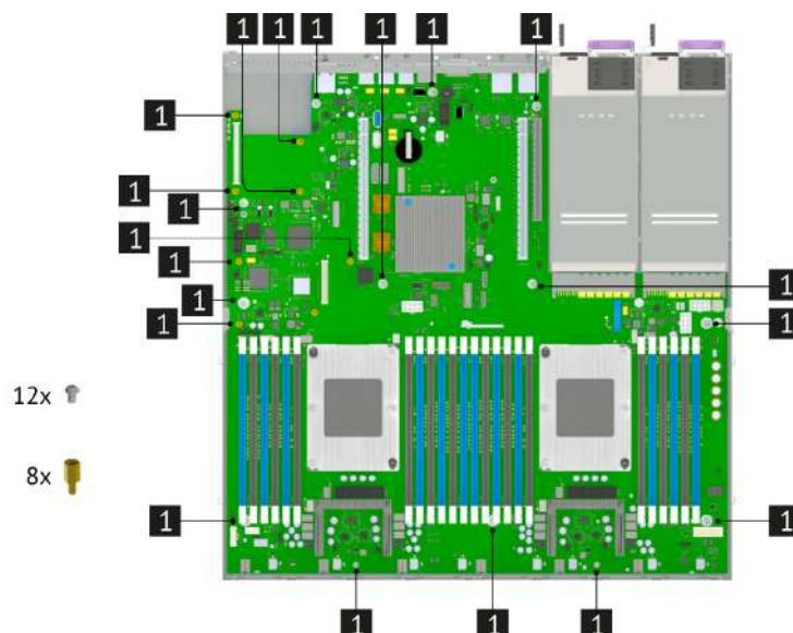
Рис. 37. Винты и стойки фиксирующие материнскую плату.
