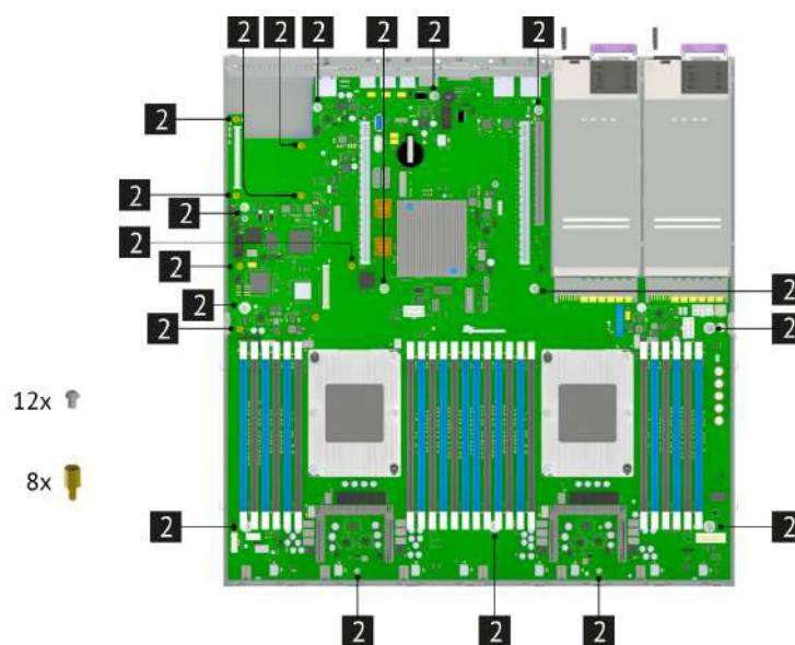
Рис. 40. Винты и стойки фиксирующие материнскую плату.
