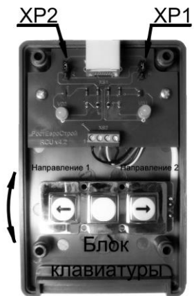
Вид пульта со снятой крышкой
