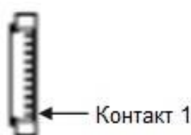
Рисунок 52. Ориентация штырькового 10-ти контактного разъема двухроторного вентилятора
