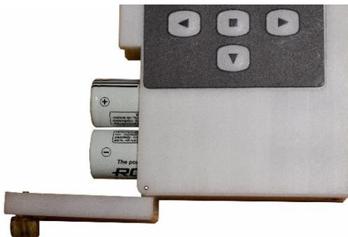
Рисунок 2.1 – Установка АКБ
