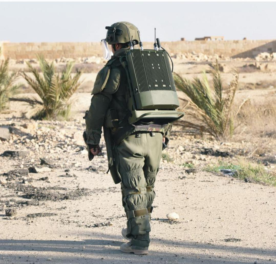
Изделие предназначено для защиты от радиоуправляемых минно-взрывных устройств повышенной мощности и функционирующих в диапазоне частот сотовой связи, как специалистов взрывотехнических служб, при проведении работ по поиску и обезвреживанию РВ У, так и личного состава МВД и ВС при выполнении прочих боевых задач.
