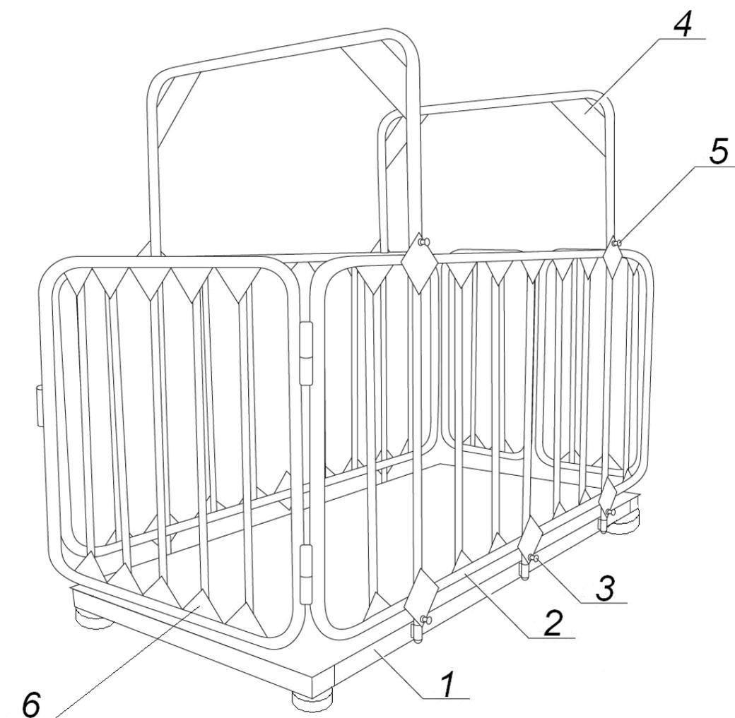
Рис. 11 Схема весов ВСП4-ЖСО
