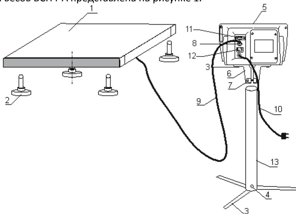
Рис.1 Схема весов ВСП4-А
