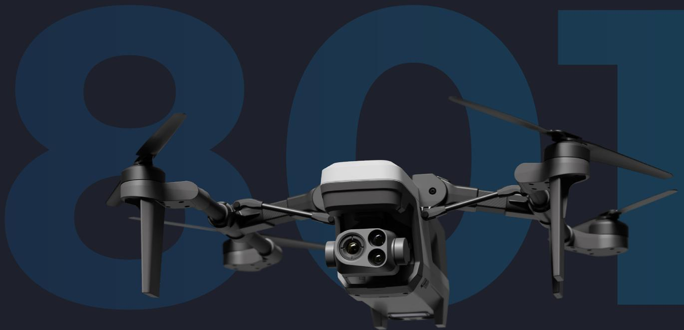
Компактный и легкий коптер для видеомониторинга в режиме реального времени. Он оснащен видеокамерой 4К и тепловизором для комплексного обследования удаленных объектов — в том числе в инфракрасном диапазоне, а благодаря помехоустойчивому каналу связи гарантирована бесперебойная трансляция видео даже в самых сложных условиях.
