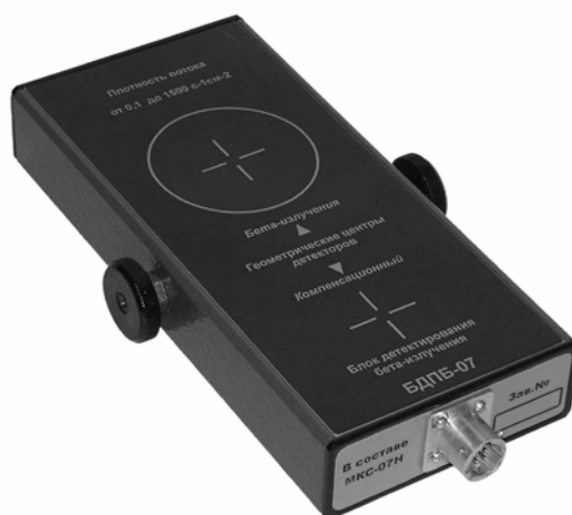
1.4.4. Внешний вид выносного блока детектирования БДПБ-07.
