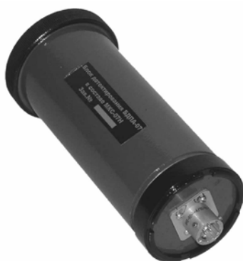
1.4.3. Внешний вид выносного блока детектирования БДПА-07.
