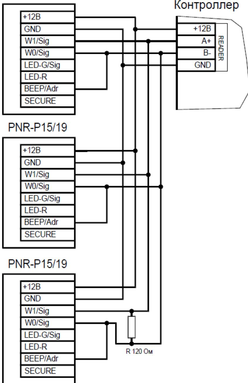
Рисунок 10. Подключение считывателя в режиме OSDP
