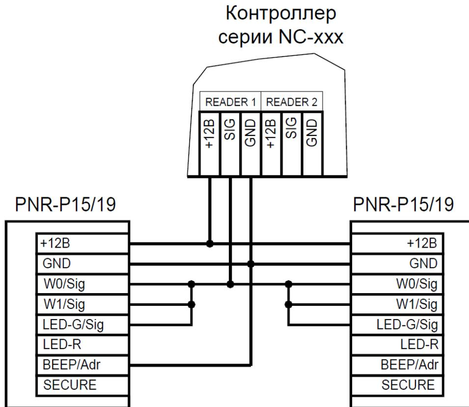
Данная модель считывателя определяет адрес в момент подачи питания. Для смены адреса необходимо выключить питание, изменить положение желтого провода (BEEP/ADR) и вновь подать питание на считыватель.
