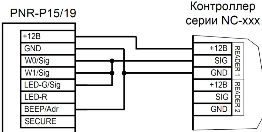
Рисунок 8. Подключение считывателя в режиме Parsec, адрес 0 (наружный)
