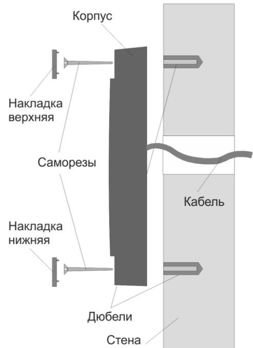
Рисунок 4. Крепление считывателя PNR-P19
