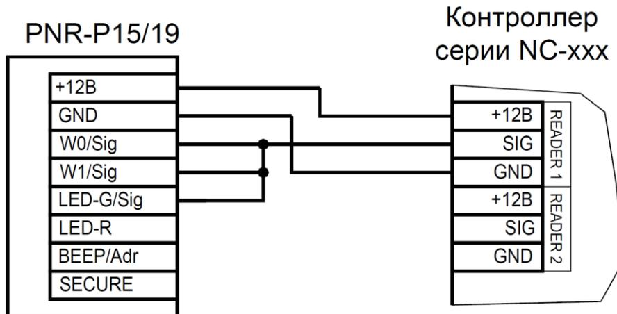
Рисунок 7. Подключение считывателя в режиме Parsec, адрес 1 (внутренний)
