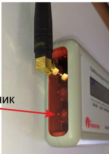
Положение оптической оси определяется по максимальному уровню сигнала, фиксируемому на дисплее прибора контроля ПК-02, перемещаемого перед излучателем в плоскости, перпендикулярной направлению оптического луча.
