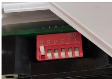
5. На экране монитора появится изображение с видеокамеры и через несколько секунд появятся информационные строки с относительными значениями параметров сигнала. Показ информационных строк можно отключить установкой переключателя «3» блока переключателей в положение «ON».
