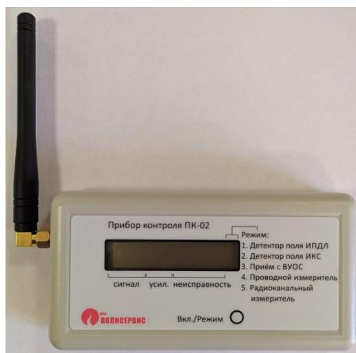
Включение прибора и выбор режима производится последовательным нажатием кнопки ВКЛ/РЕЖИМ на лицевой панели прибора контроля ПК-02. Прибор имеет 5 режимов работы. Для настройки однопозиционных ИПДЛ могут использоваться режимы «Детектор поля» и «Проводной измеритель».
